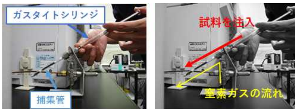
図3 加熱脱着装置などに付随するガス捕集装置による希釈の例
